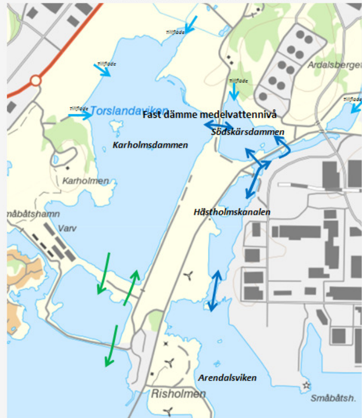
Fig. 12b. Vattenregim i Torslandaviken. Ljusblå pilar tillflöden sötvatten, mörkblå pilar tillflöden från älvfjorden, gröna pilar till och frånflöde från det planerade vadehavt (pumpning).
